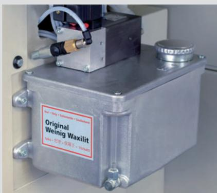
К высокопроизводительному станку лучше приобрести автоматический насос. Интервалы его срабатывания можно задавать через реле времени, расположенное в электрошкафу.
